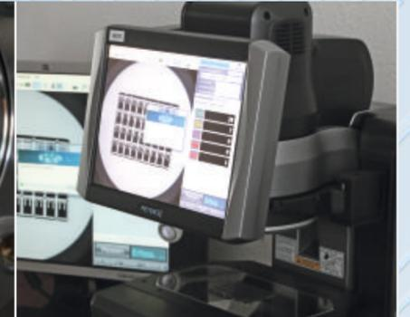
Messprojektor zur effizienten Kontrolle der Geometrie von Sensorsubstraten in der Serieproduktion
